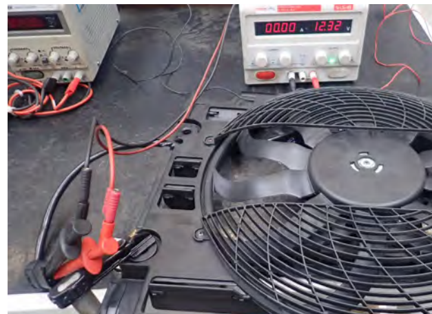
Fig. 1 Comprobación del ventilador
