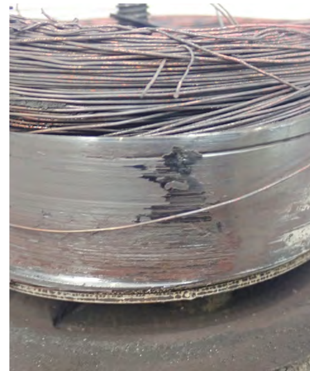
Fig. 1 Rastros de rozadura en el cuerpo de la bobina y la bobina quemada
