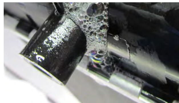
Fig. 2 Grieta en la fijación
