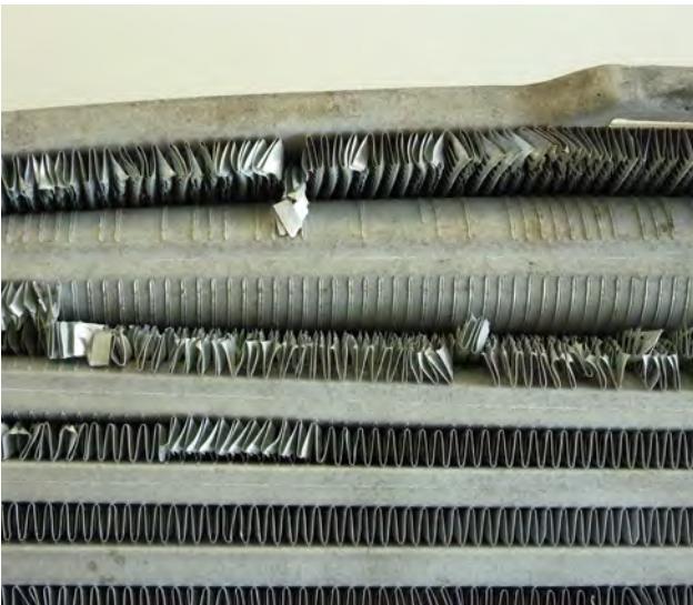
Fig. 3 Tubo del radiador hinchado
