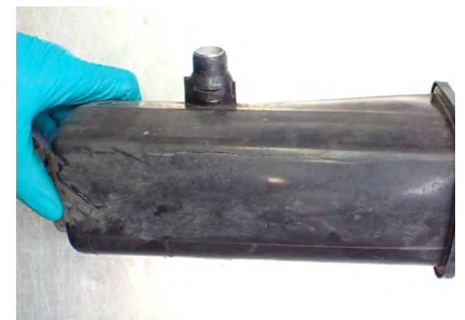
Fig. 2 Depósito de expansión reventado
