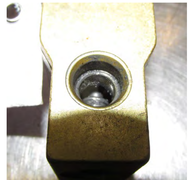
Fig. 2 Impurezas en la válvula de expansión
