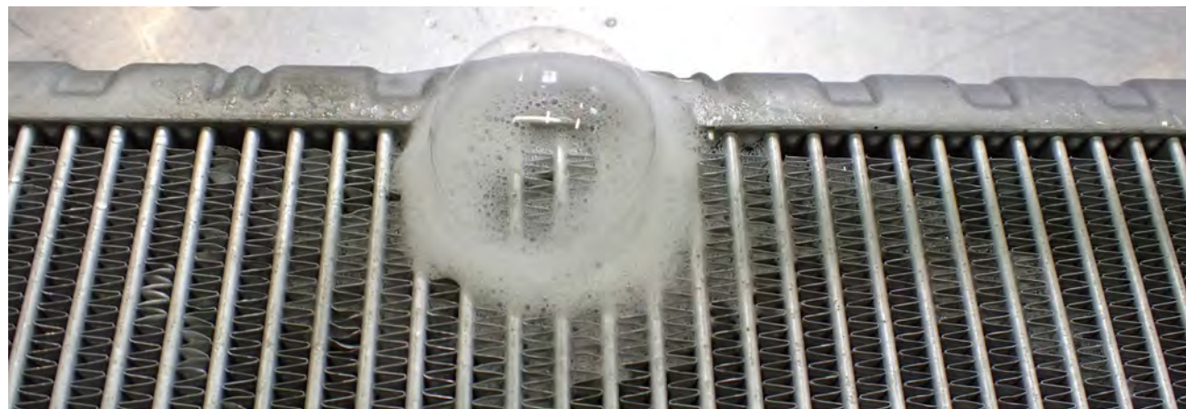
Fig. 3 Evaporador con fugas
