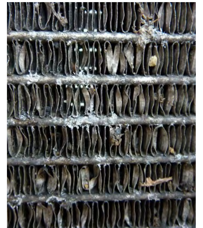
Fig. 2 Impurezas y aletas del radiador deformadas
