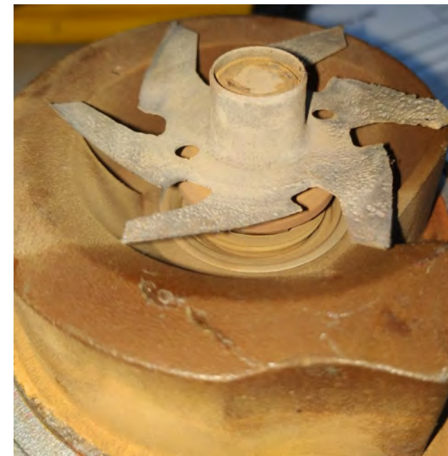
Fig. 1 Cavitación en la bomba de refrigerante del motor
