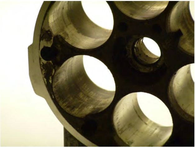
Fig. 2 Gripado en el cilindro
