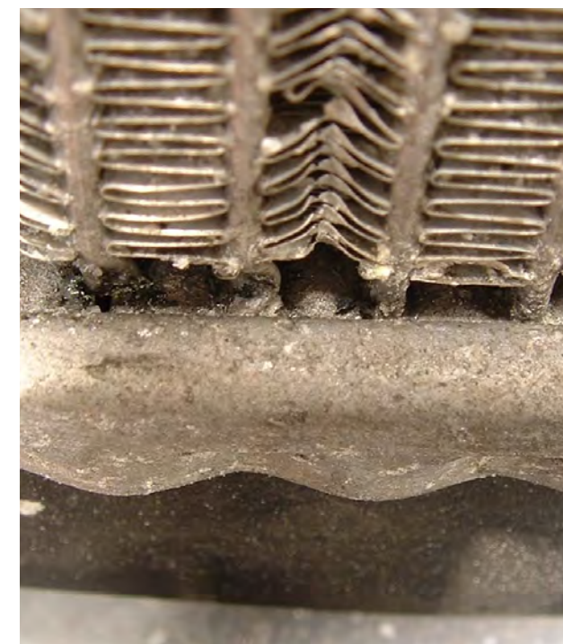
Fig. 1 Corrosión en el radiador
