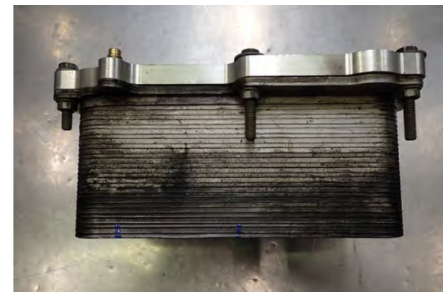
Fig. 1 Radiador de aceite con fugas
