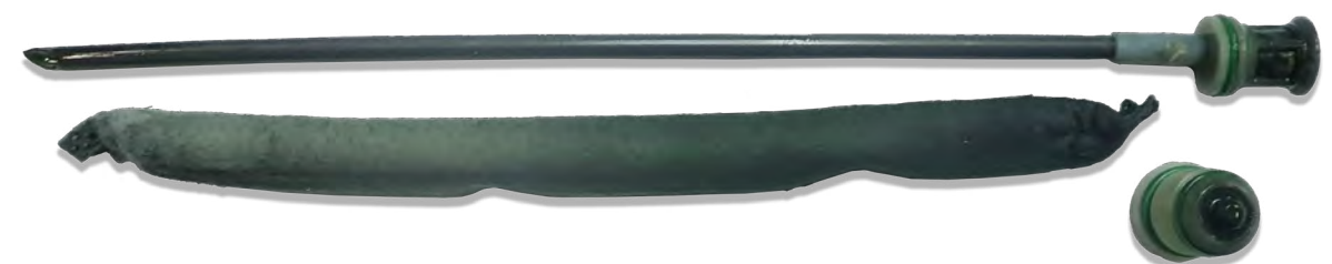
Fig. 3 Filtro deshidratador obstruido
