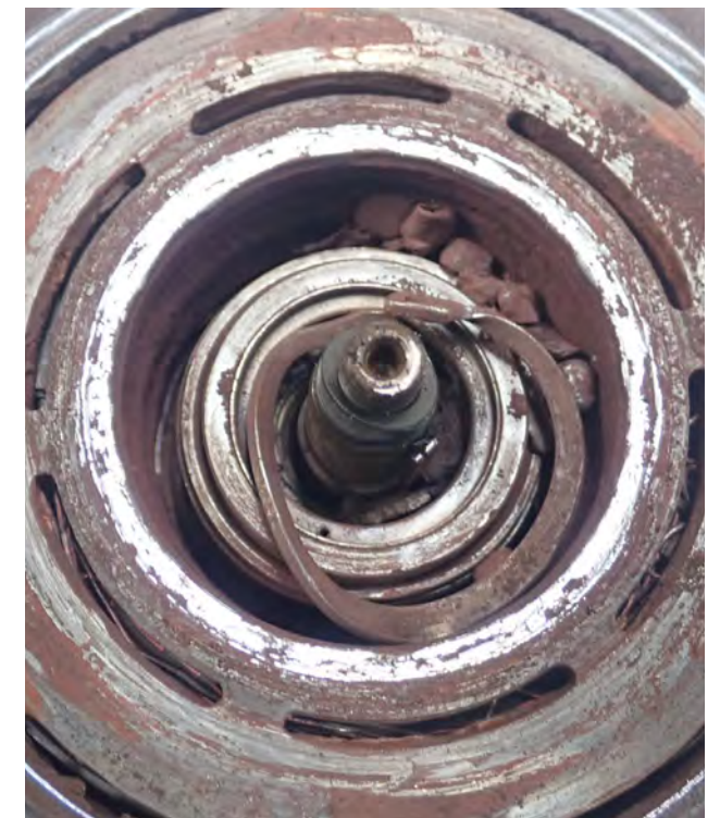
Fig. 2 Rodamiento de bolas defectuoso
