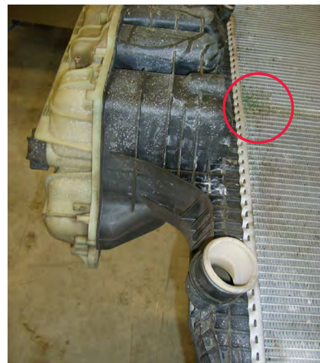
Fig. 1 Radiador con fugas aparentes
