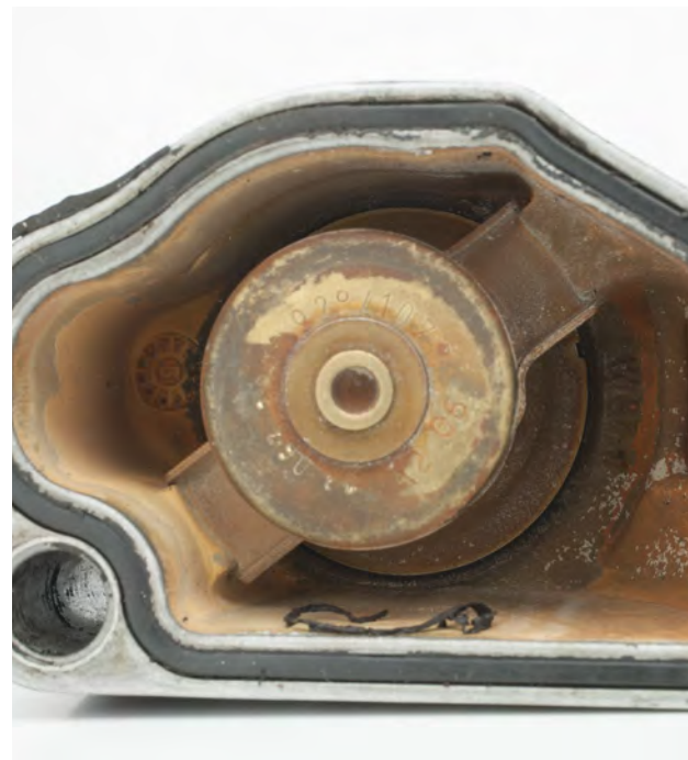
Fig. 2 Corrosión en el termostato
