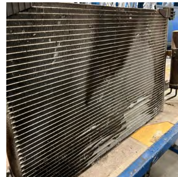
Fig. 1 Corrosión en el condensador
