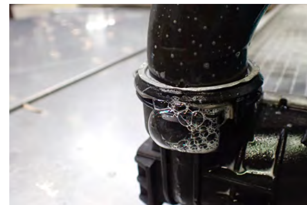
Fig. 2 Enchufe rápido con fugas
