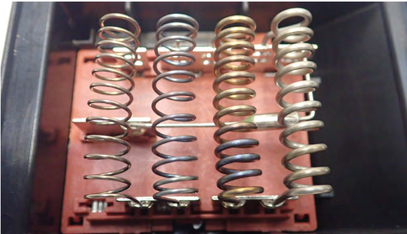
Fig. 3 Regulador sobrecargado por un ventilador defectuoso
