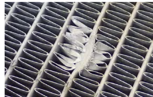
Fig. 1 Daño mecánico
