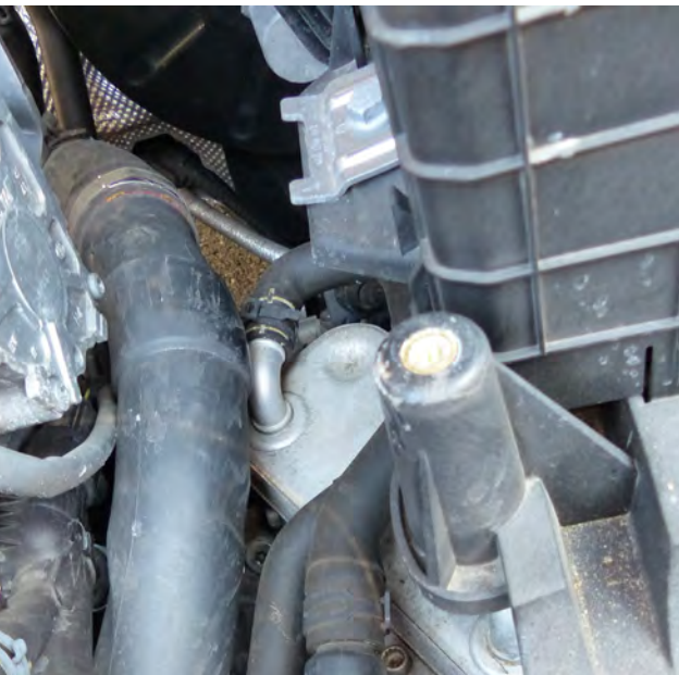
Fig. 1 Intercambiador de calor de transmisión
