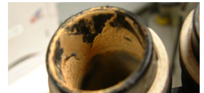
Fig. 3 Corrosión y sedimentos en el circuito de refrigerante
