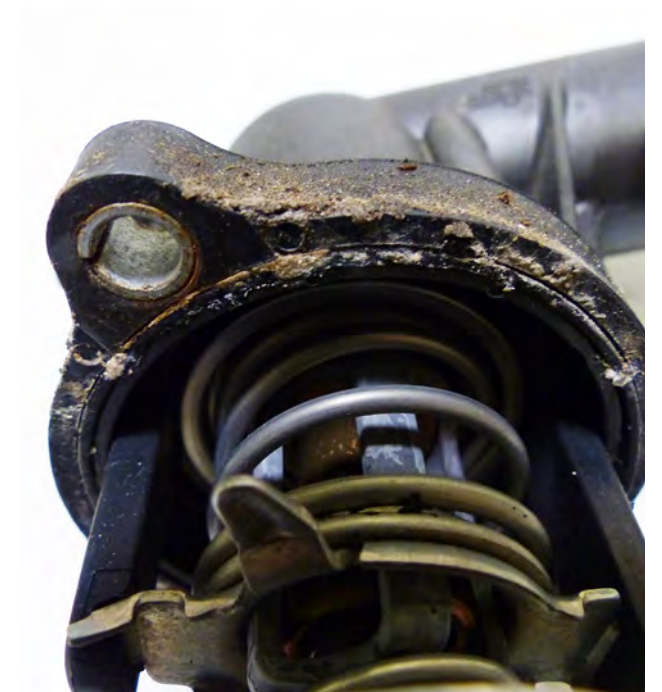
Fig. 2 Junta dañada por la junta líquida
