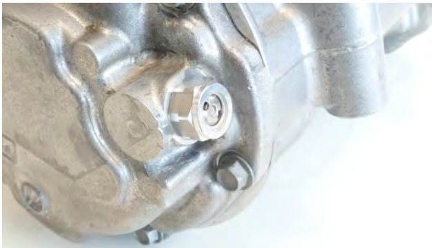
Fig. 1 La válvula de sobrepresión se ha activado
