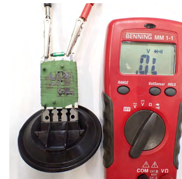
Fig. 1 Prueba del regulador quemado
