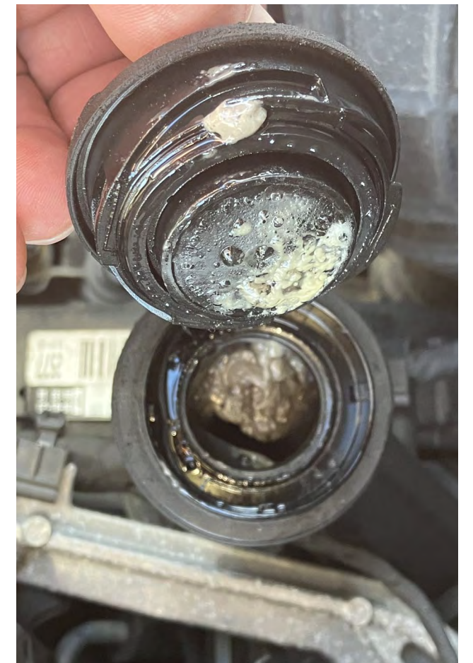
Fig. 3 Emulsión de aceite y agua en el racor de llenado de aceite
