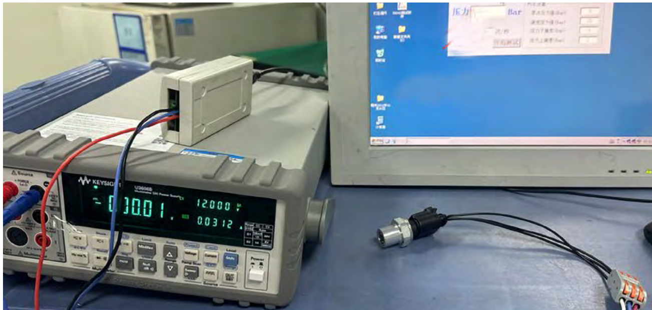
Fig. 4 Comprobación de un presostato en el laboratorio
