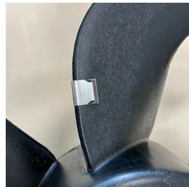
Fig. 1 Abrazadera metálica como peso para equilibrar
