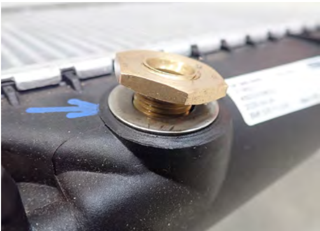
Fig. 3 Conexión roscada de la tubería de aceite de transmisión
