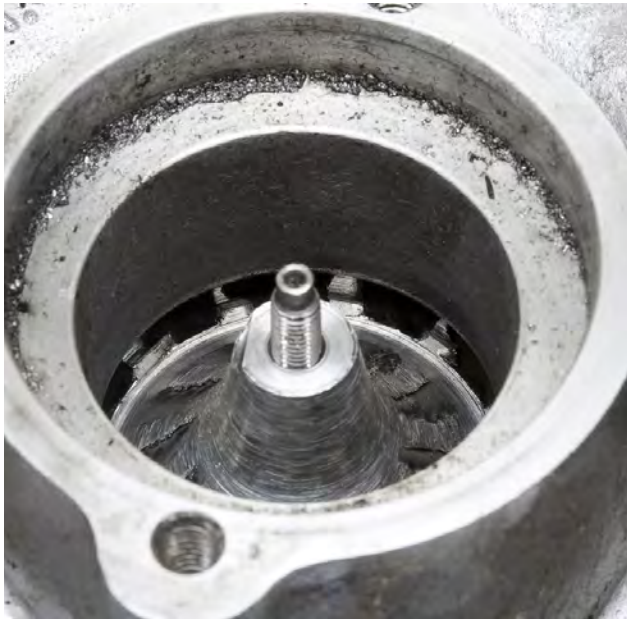
Fig. 2 Virutas por daños del turbocompresor
