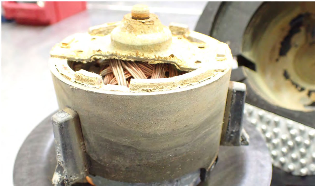
Fig. 4 Corrosión en el motor del ventilador
