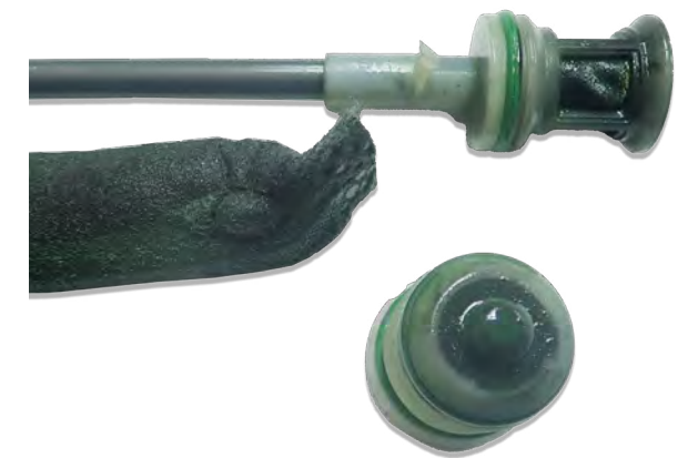
Fig. 2 Filtro deshidratador obstruido
