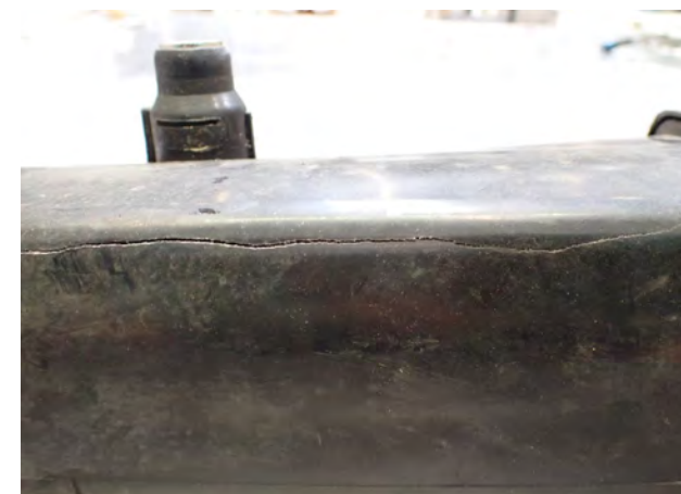
Fig. 1 Fisura en el depósito de expansión
