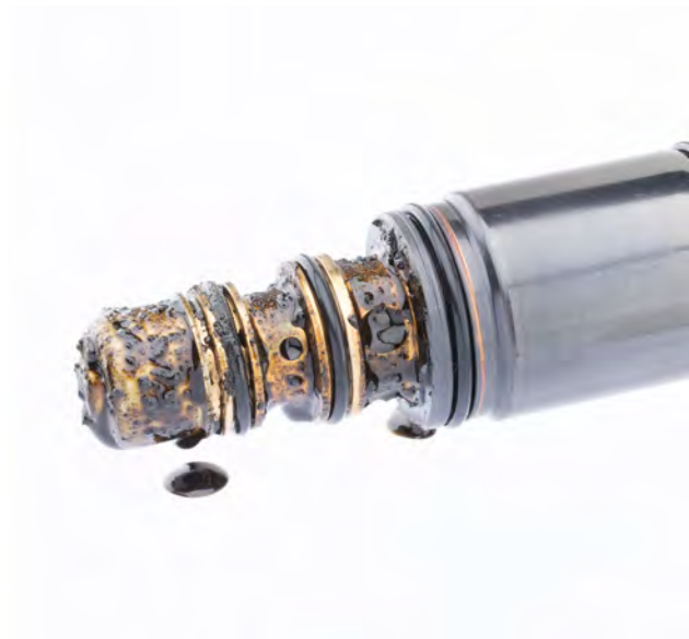
Fig. 4 Virutas y aceite negro en la electroválvula
