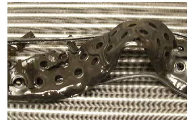
Fig. 1 Junta hinchada en el radiador del refrigerante
