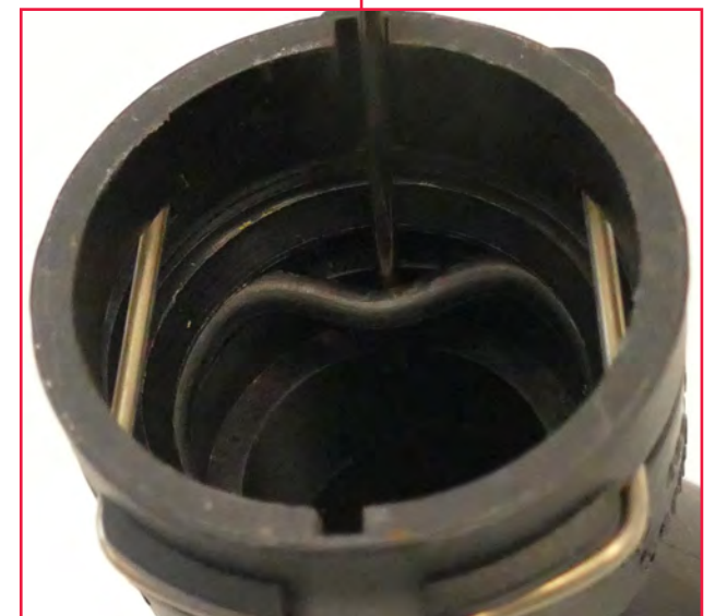
Fig. 3 Sustituir junta tórica
