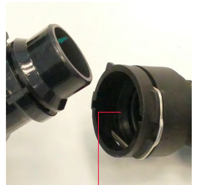
Fig. 2 Enchufe rápido
