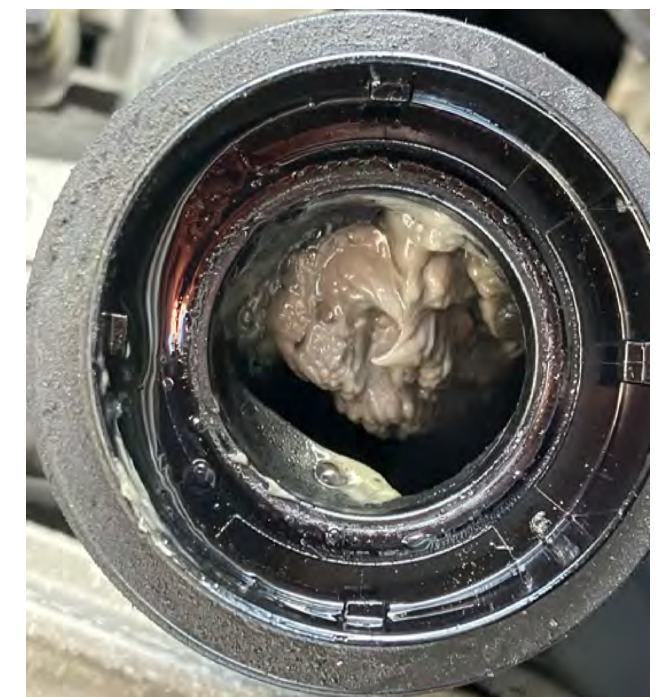
Fig. 3 Emulsión de aceite y agua en el racor de llenado de aceite
