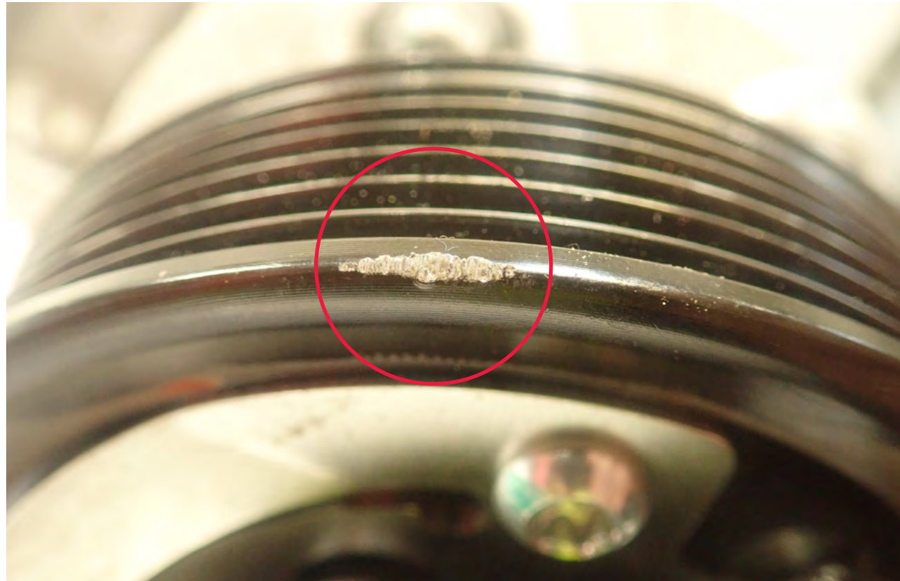
Fig. 1 Polea dañada
