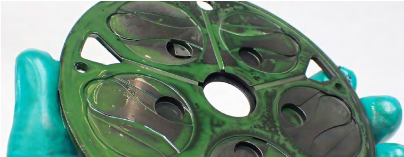
Fig. 1 Válvula rota
