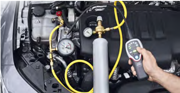
Fig. 1 Detección de fugas con gas de formación
