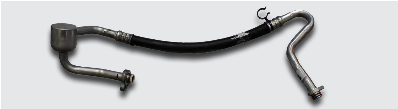
Fig. 3 Conducto AP doblado
