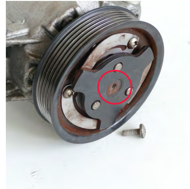
Fig. 1 Tornillo central aflojado
