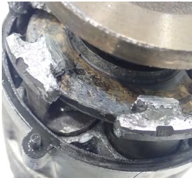
Fig. 3 Gripado en pistones y el plato cíclico
