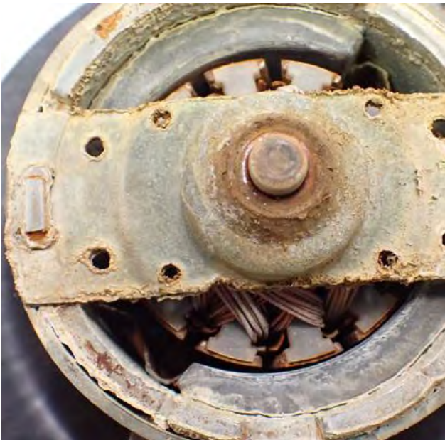
Fig. 1 Daño en el cojinete del motor del ventilador
