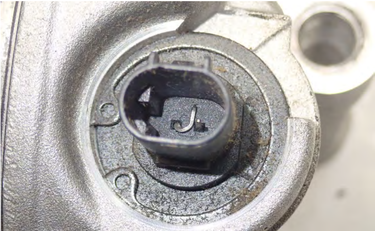
Fig. 1 Pin deformado
