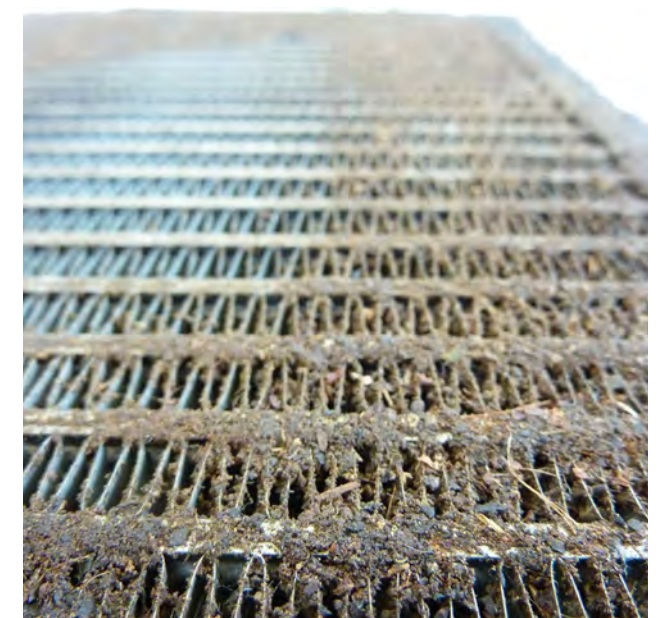
Fig. 2 Evaporador obstruido
