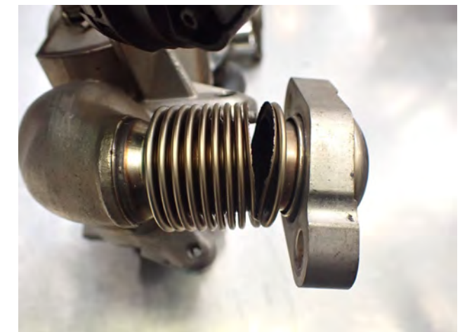
Fig. 2 Tubo flexible desgarrado del radiador EGR
