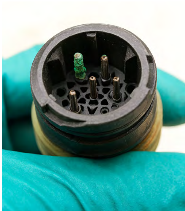
Fig. 1 Corrosión en el enchufe
