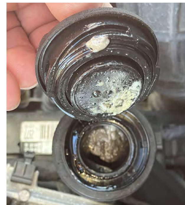
Fig. 2 Emulsión de aceite y agua en la tapa de llenado de aceite y el racor de llenado de aceite
