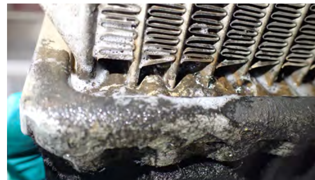
Fig. 4 Corrosión exterior en el radiador
