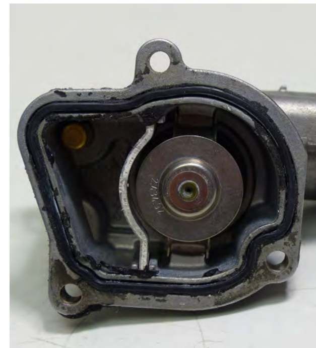
Fig. 1 Junta líquida en la carcasa del termostato
