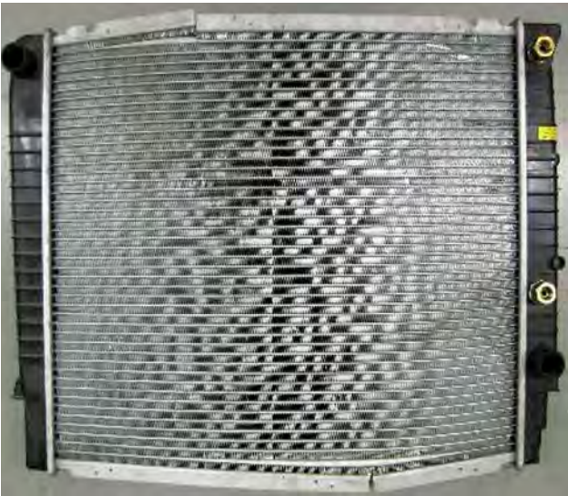
Fig. 1 Radiador del refrigerante del motor hinchado
