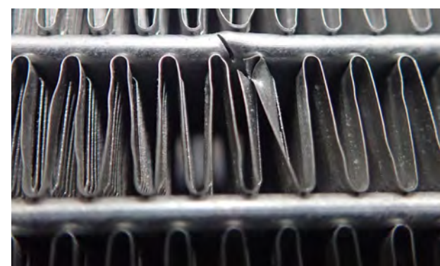
Fig. 3 Daños mecánicos (corte)
