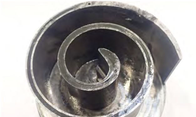
Fig. 1 Espiral del compresor scroll muy desgastada
