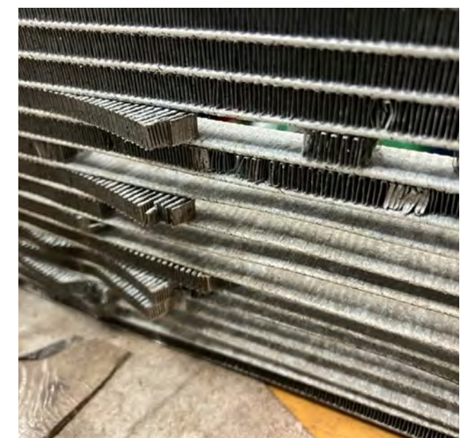
Fig. 2 Aletas del radiador corroídas
