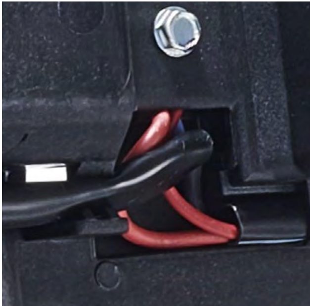
Fig. 2 Rotura de cable en el control del ventilador
