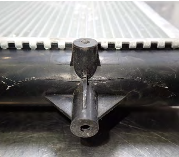
Fig. 2 Depósito de agua reventado
